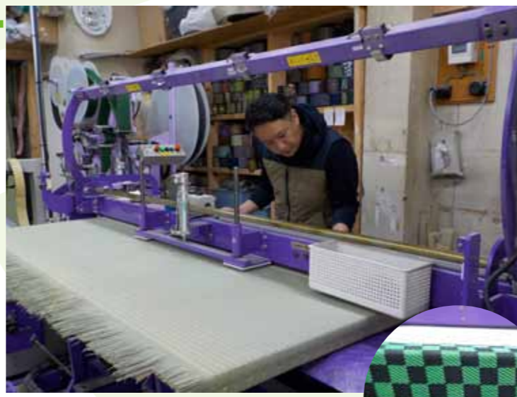
畳縁を縫い付ける「両用機」 右の畳縁は人気漫画『鬼滅の刃』の主人公、竈門炭治郎をイメージしたカラー
