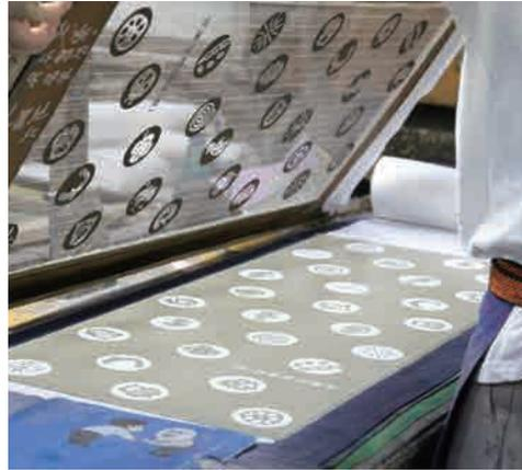
型紙を木枠に貼り、生地を手ぬぐいの長さにおり返しながら型を置き、1枚1枚に糊をつけていきます。糊付けを終えたら、反物の両面におがくずをつけます。(糊が流れるのを防ぐことができ、ベタベタをおさえられます。)
