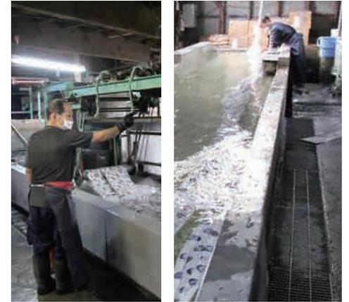
機械を使って勢いよく糊を洗い落とし、脱水機で水を切りって天日干しをします。
