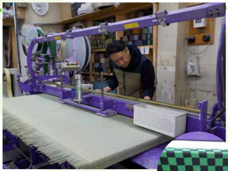
たたみべりぬ つ りょうようき 畳縁を縫い付ける「両用機」 右の畳縁は人気漫画『鬼滅の刃』の主人公、竈門炭治郎をイメージしたカラー
